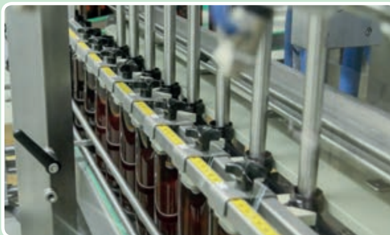
Inox poli brillant: la nouvelle ligne de remplissage s'étend du transfert au remplissage au vissage.
